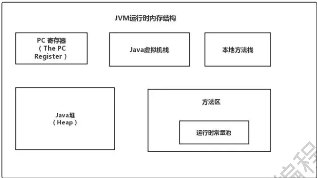
程序计数器：当前线程所执行的字节码的行号指示器，用于记录正在执行的虚拟机字节指令地址，线程私有。
